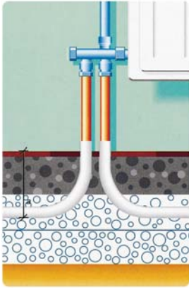
Kuva 5. Putken taivutus pinalattiassa a = min 48 mm (Ø 12), min 58 mm (Ø 15)
